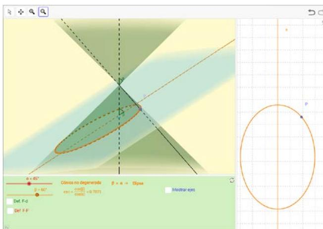
3D orientable de una superficie cónica y un plano  $\omega$  que la corta, a la que se puede añadir una o dos esferas tangentes a cono y plano (*Esferas de Dandelin*), y una vista del plano sección  $\omega$  con la cónica y otros elementos contenidos en él. En ambas vistas se visualiza un punto **P** que puede desplazarse por la cónica.
